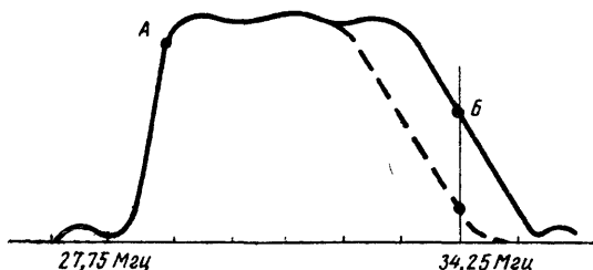
Рис. 46. Влияние регулятора четкости на частотную характеристику УПЧ канала изображения
